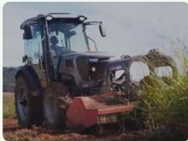
Trincha em talude
